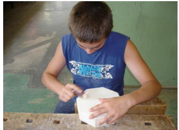
16 Kanten bündig schleifen,
