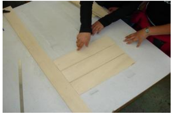
2 Die Dauben zur Montage auf Klebestreifen ausrichten
