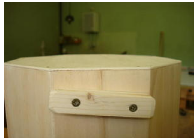
18 Halteleisten sägen, bohren, senken, verleimen und aufschrauben
