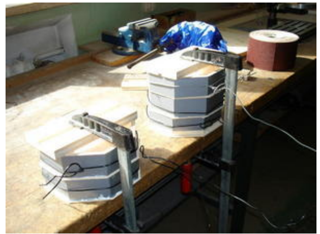
13, 14, 15 Schlagfläche aufleimen und mit Stiften fixieren. Werkstücke zum Trocknen einspannen.
